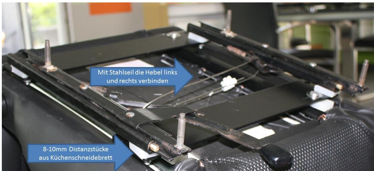
Jetzt den ganzen Sitz wieder in die Löcher des Mustang einsetzen und von unten wieder verschrauben. Gummistopfen drauf (am besten neue) – Fertig!
